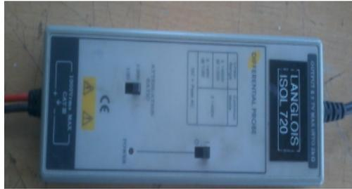
FIGURE D3 – Capteur de tension.
