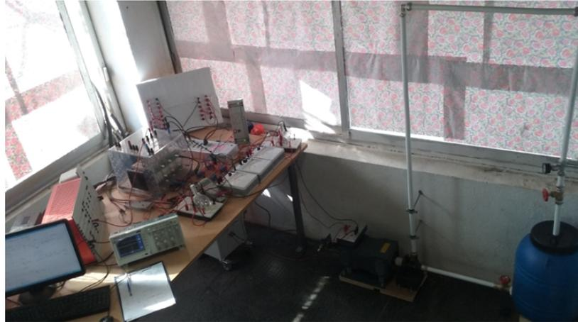
FIGURE 5.21 – Installation expérimentale du système de pompage PV.
