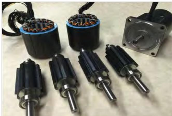
Figure 1.3 Machine à reluctance variable [5]
