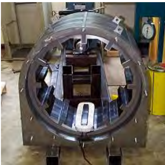
Figure -I.16- Stator et rotor d'une machine à réluctance variable de 20 kW
