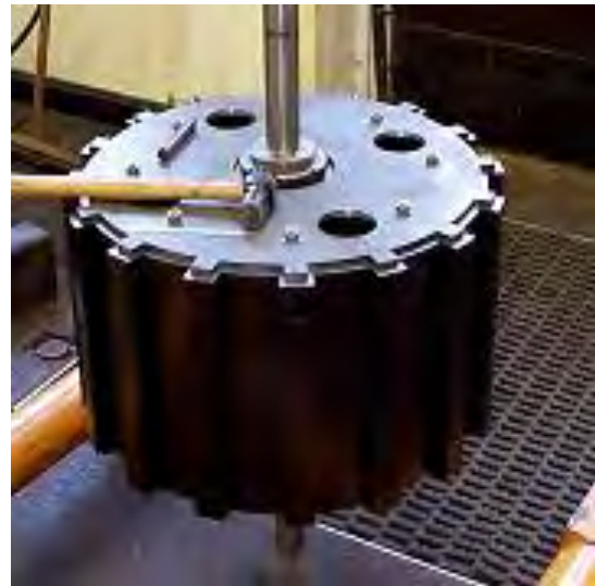
Figure -I.16- Stator et rotor d'une machine à réluctance variable de 20 kW
