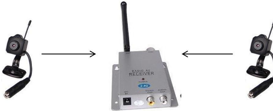
**FIG I.1** Exemple de deux cameras sans fils et un seule receveur.
