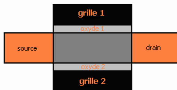
Figure I.17 : Schéma d'une structure de double grille
