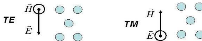
**Figure 1.5 :** Décomposition du champ électromagnétique suivant ses deux polarisations TE et TM.
