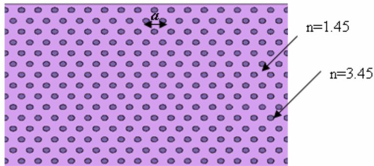
**Figure 3.1 :** Schéma d'un CP 2D formé par un réseau triangulaire de pas  $a = 0.465\mu\text{m}$  de tiges cylindriques d'indice de réfraction  $n = 3.45$  plongées dans une matrice de diélectrique tel que  $n = 1.45$ .
