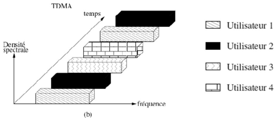
Fig.3.2 L'accès multiple TDMA
