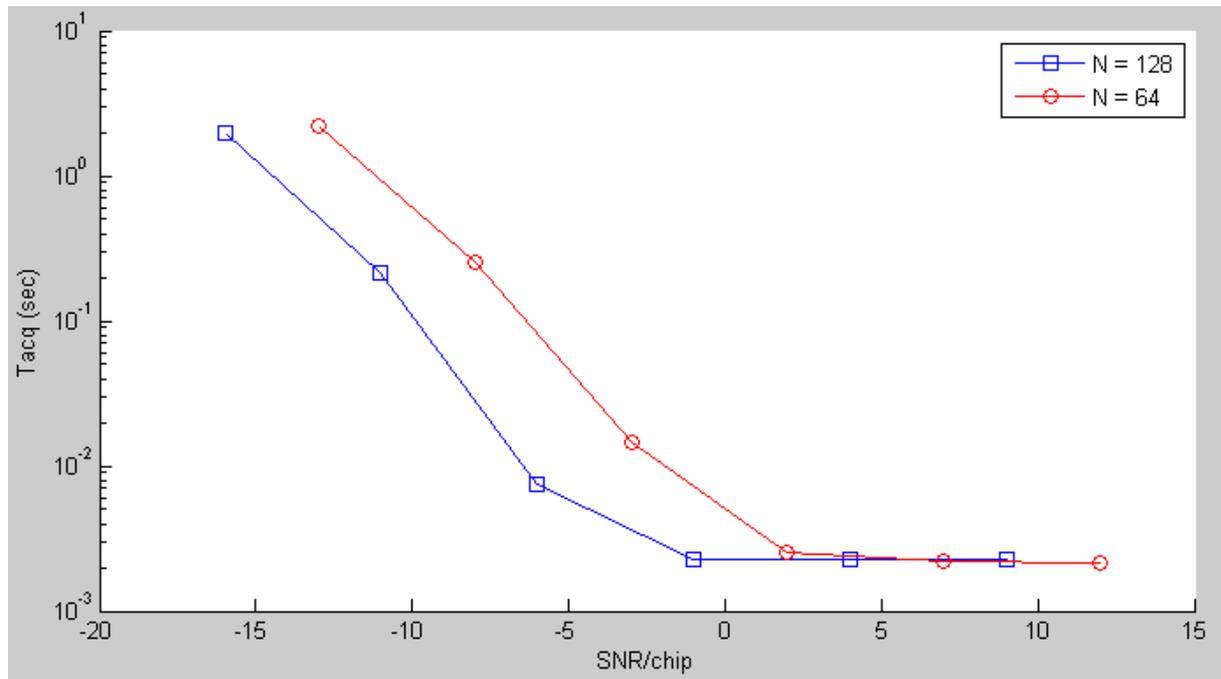
Fig.4.26 Temps d'acquisition moyen utilisant  $D^*$ ,  $M=4$ ,  $L_p=4$ ,  $N_c=16$
