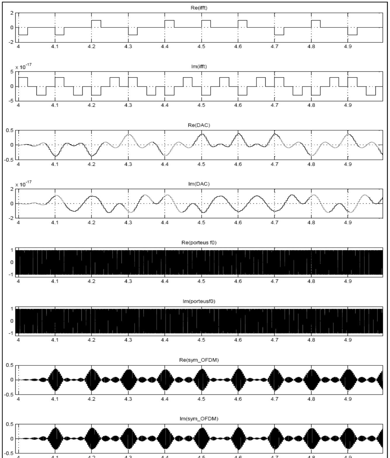
Fig.4.15 Les signaux à travers les différents blocs du modulateur MC-DS-CDMA
