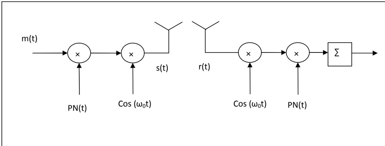
Fig.3.6 Schéma général d'un système à étalement de spectre en séquence directe
