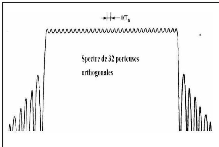
Fig.2.3 Spectre en sortie du modulateur OFDM
