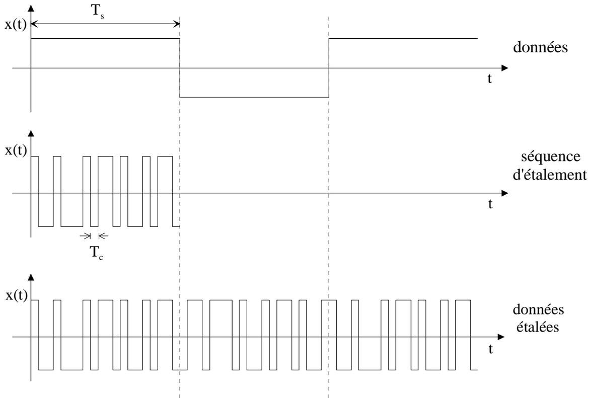
Fig.3.4 Etalement d'une séquence de données
