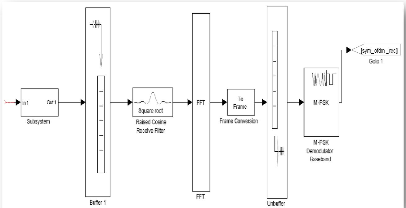
Fig.4.8 Démodulateur OFDM
