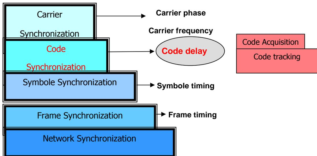
Fig.1.1. Niveaux de Synchronisation dans une Communication à spectre étendu.
