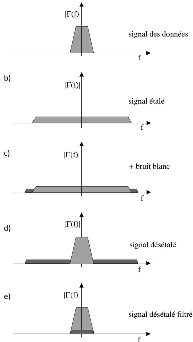
Fig.3.5 Bilan spectral d'une transmission à étalement du spectre
