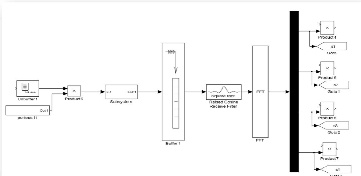
Fig.4.10 Démodulateur OFDM
