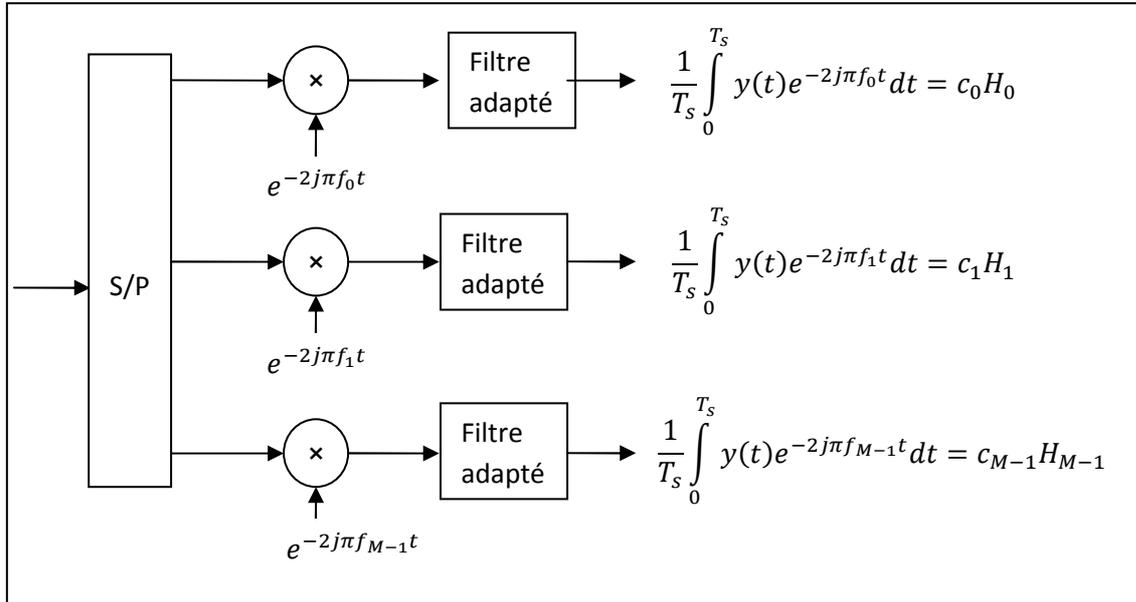
Fig.2.4 Principe de la démodulation classique
