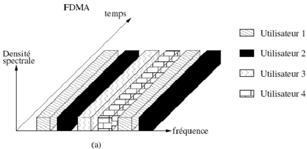
Fig.3.1 L'accès multiple FDMA
