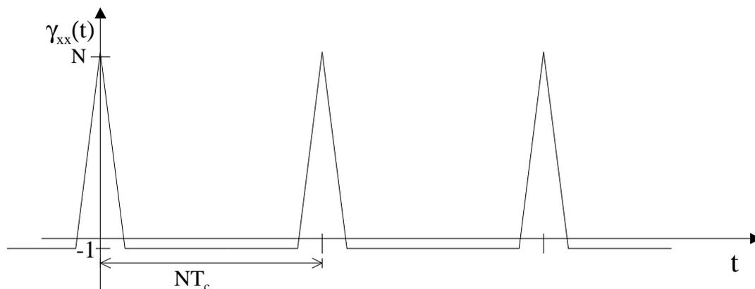
Fig.3.7 Autocorrélation d'une séquence pseudo-aléatoire de longueur maximum
