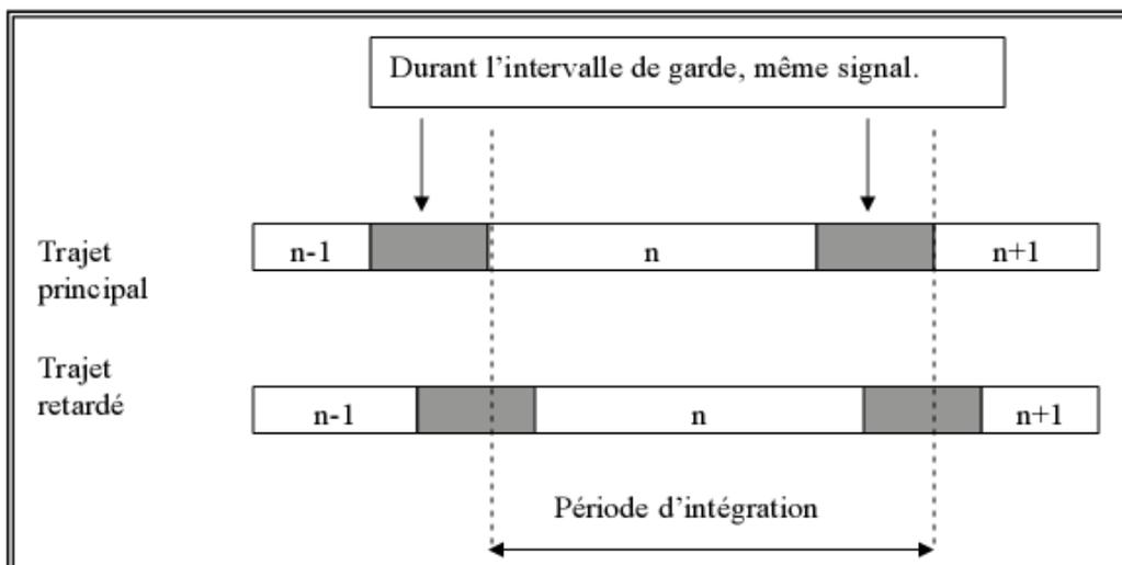
Fig.2.10 Intégration du signal avec intervalle de garde
