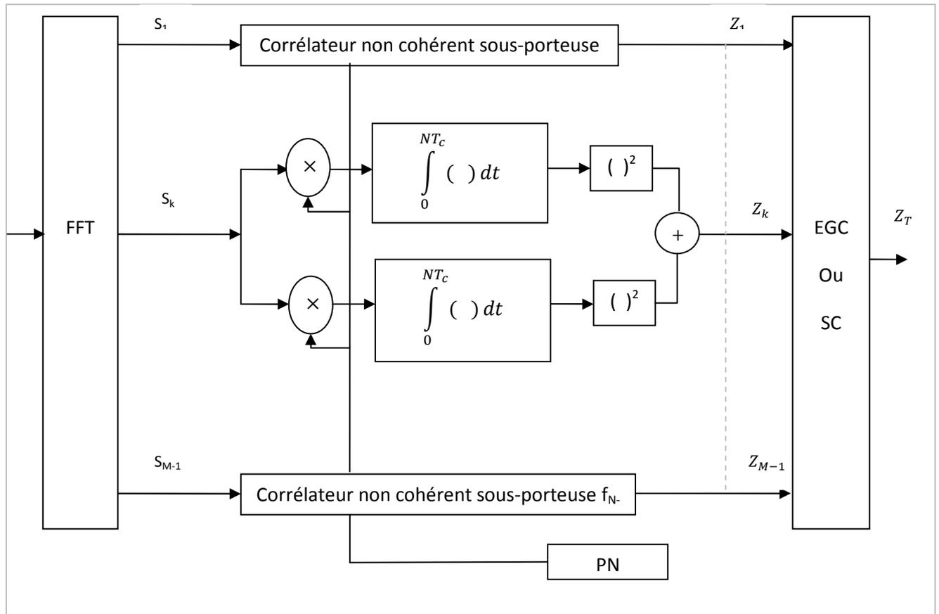
Fig.4.18 le block de corrélation avec la combinaison EGC
