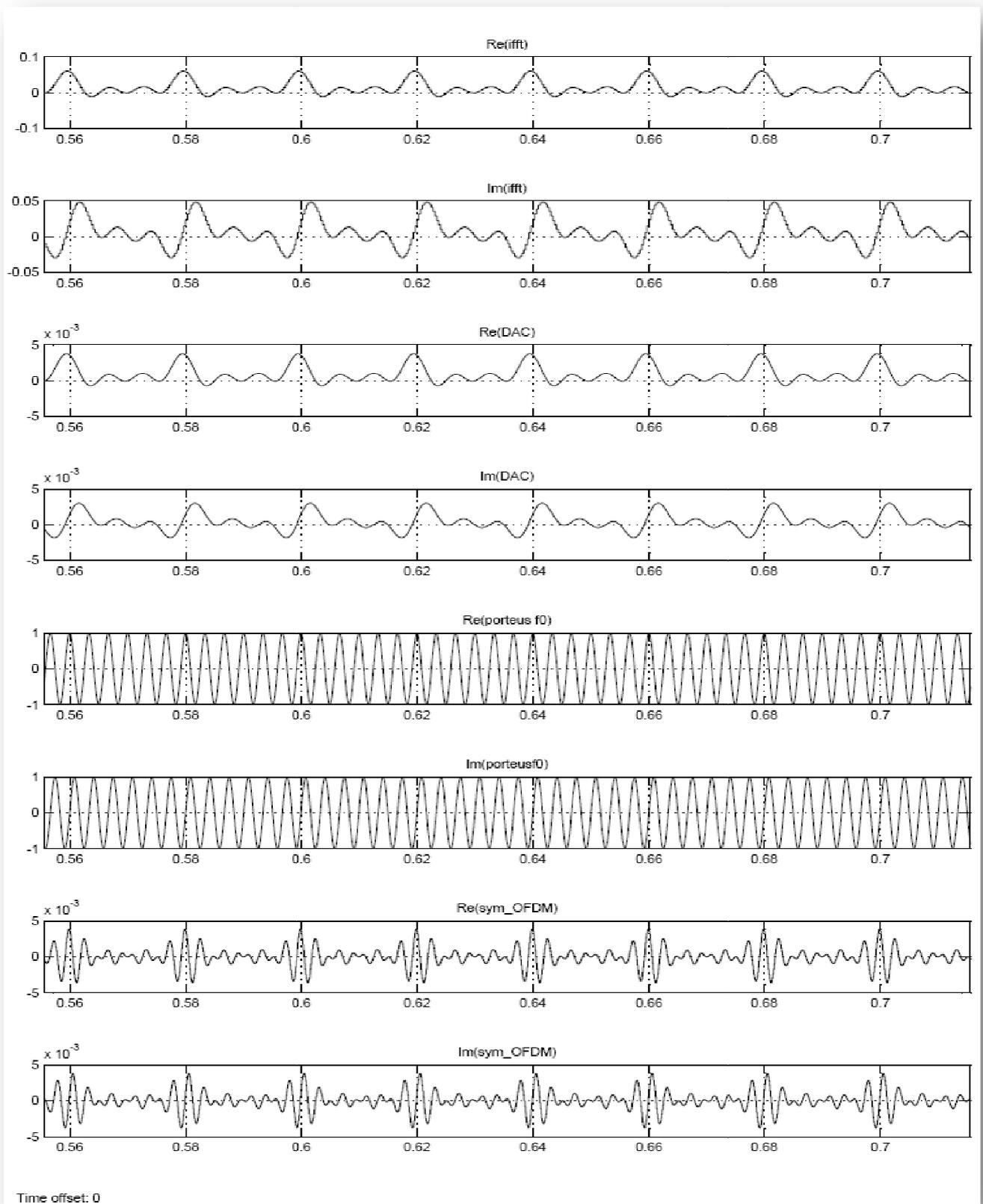
Fig.4.7 Les signaux à travers les différents blocs du modulateur OFDM
