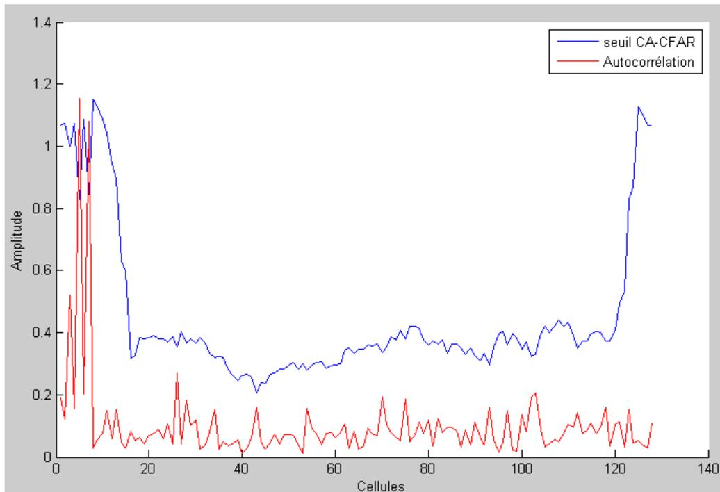
Fig.4.23 Seuil du Detecteur CA-CFAR pour SNR/chip = -1 dB
