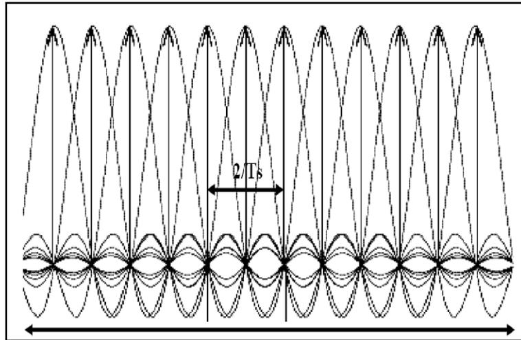
Fig.2.2 Spectre en sortie du modulateur OFDM
