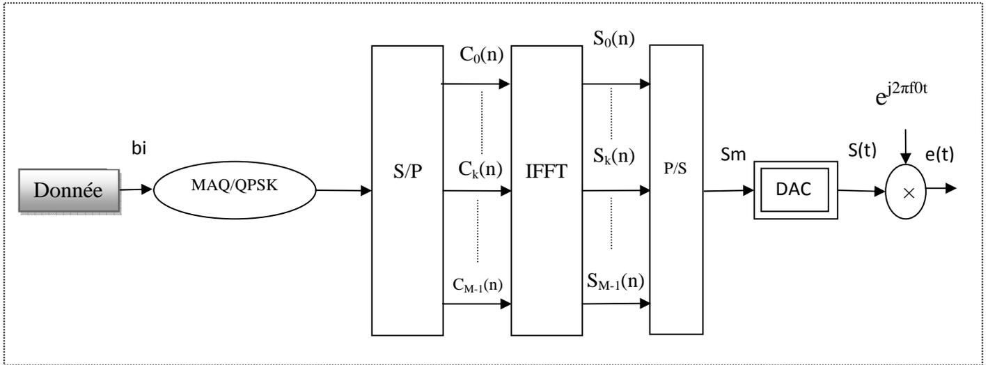
Fig.2.5 Modulateur OFDM numérique
