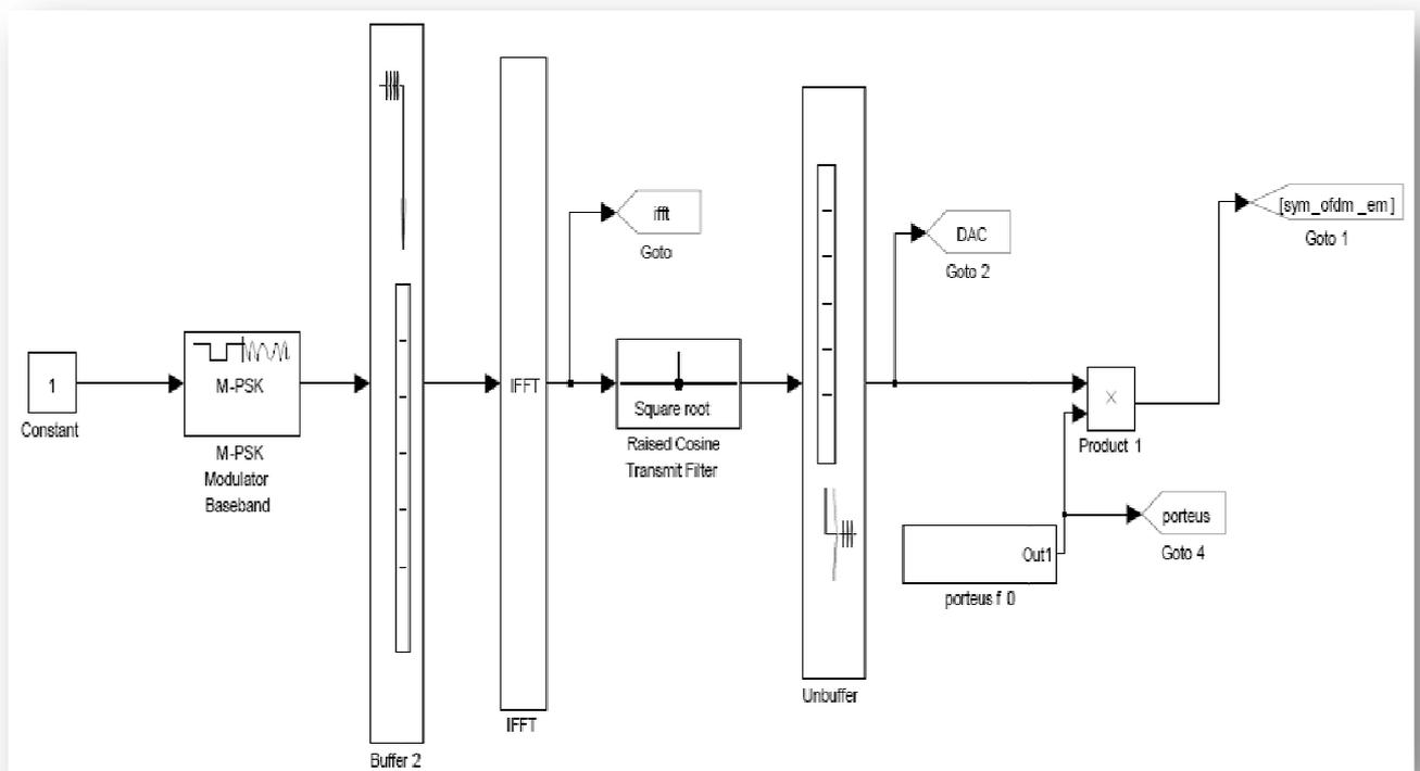
Fig.4.3 Le modulateur OFDM
