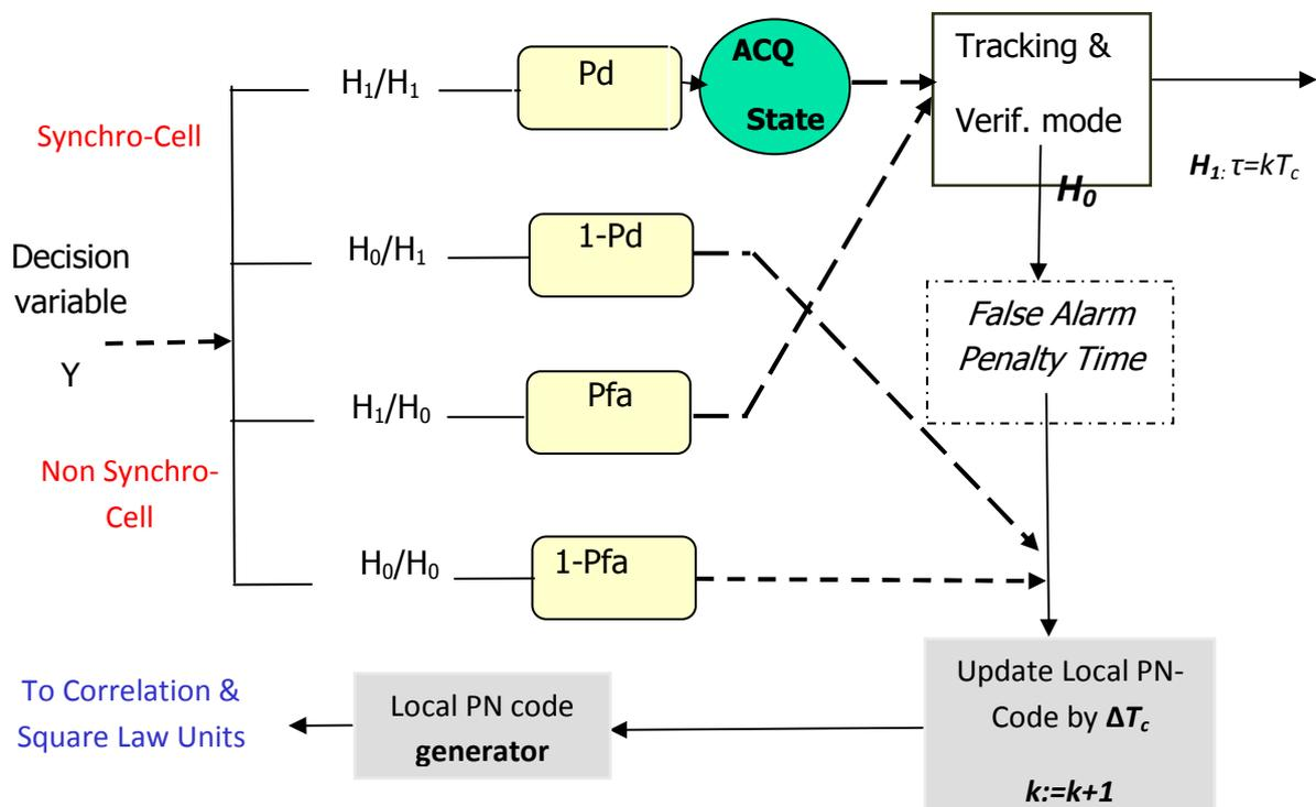
Fig.1.2 Procédure de recherche de la phase d'alignement.
