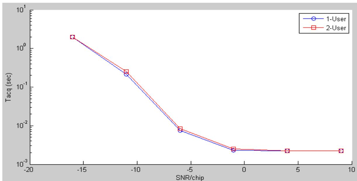
Fig.4.27 Temps d'acquisition moyen utilisant le détecteur  $D^*$ ,  $L_p=4$ ,  $N=128$ ,  $N_c=16$ ,  $M=4$
