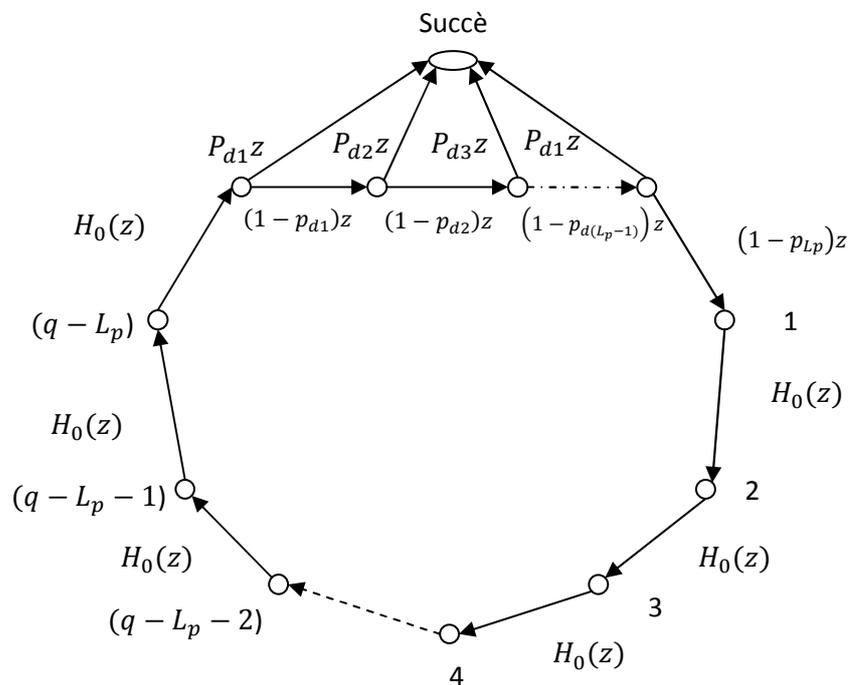
Fig.4.20 Diagramme d'état circulaire pour un système d'acquisition à recherche série
