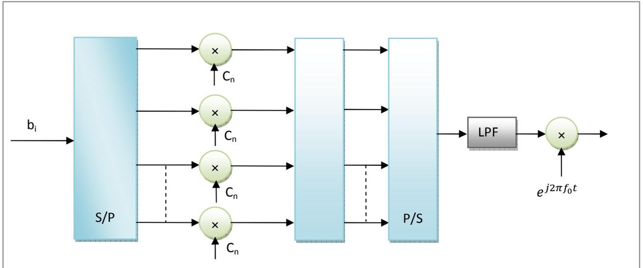
la séquence du code de l'utilisateur  $j$ , les autres opérations sont identiques au cas de la MC-CDMA. Dans ce cas les bits  $b_i^j$  arrivant avec un débit égal  $R_b$ . Ce débit est réduit à  $R_b / M$  à la fin de la conversion S/P. Ensuite, on produit un débit  $R_b G / M$  à cause de l'étalement, où  $G$  est le facteur d'étalement. Le spectre de fréquence à la sortie de l'émetteur est un spectre OFDM, où l'espace entre deux fréquences adjacentes est  $f_d = R_b G / M$ .
