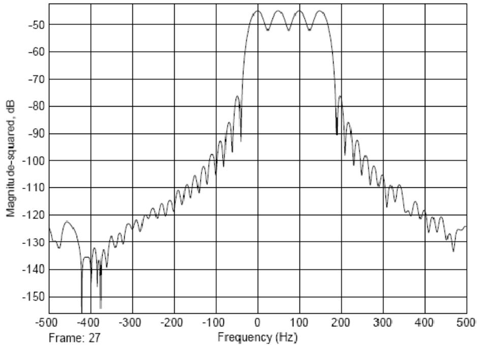
Fig.4.5 le spectre du symbole OFDM sans la porteuse  $f_0$
