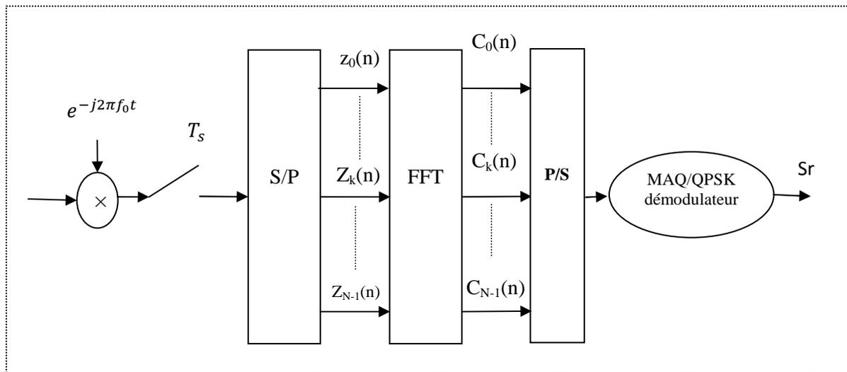
Fig.2.6 Démodulateur OFDM numérique
