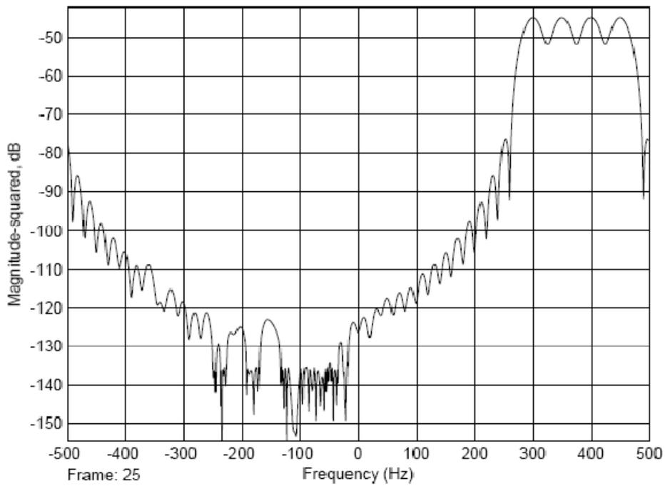
Fig.4.6 le spectre du symbole OFDM avec la porteuse  $f_0$
