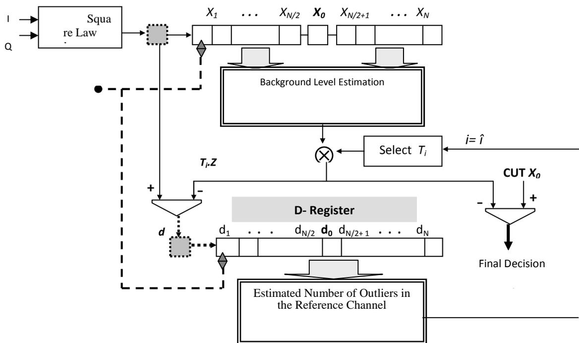
Fig.4.19 Architecture du détecteur CFAR à censure automatique
