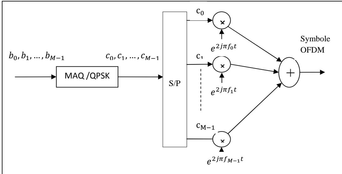
Fig.2.1 Principe de la Modulation OFDM
