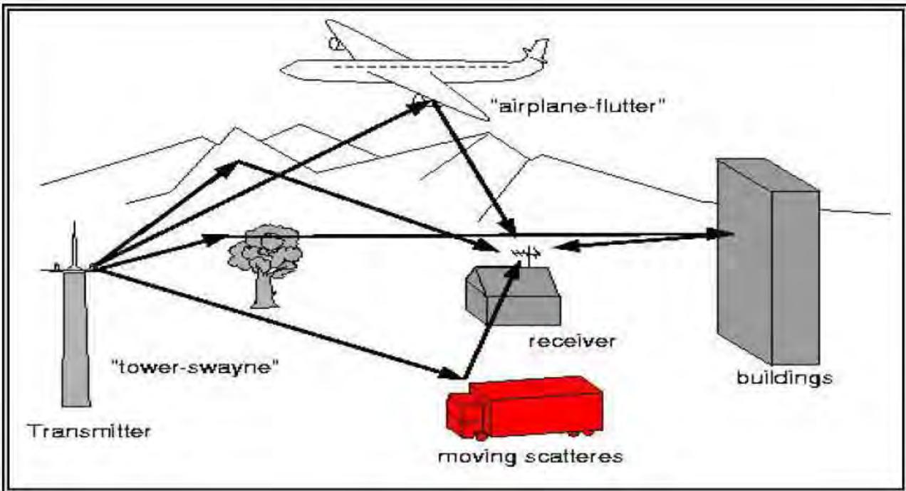
Fig.2.7--Trajet multiple dans un canal de communication
