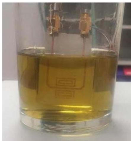
Figure II.38 Image d'un capteur immergé dans l'huile d'olive pour la caractérisation diélectrique [65]
