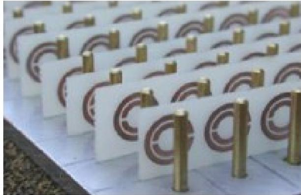
**Figure 1.17** La structure proposée par D. Smith qui combine les fils minces et les SRR pour avoir un milieu doublement négatif [73].
