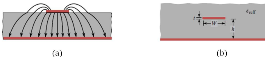
FIGURE 1.20 – (a) Ligne micro-ruban et ses lignes de champ électrique, (b) son schéma effectif.
