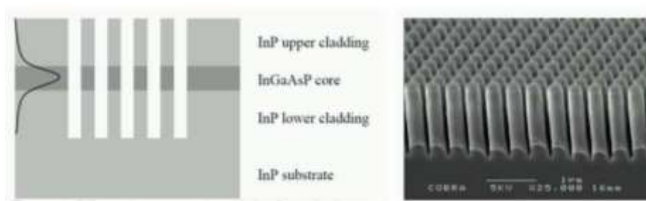
Figure I.29 Exemple de réalisation d'un cristal photonique membranaire à faible contraste d'indice verticale (coeur de InGaAsP dans l'InP). Afin de limiter les pertes verticales, la gravure doit être suffisamment profonde pour qu'il y ait recouvrement entre les trous et le profil d'intensité du mode guidé. Source COBRA, Eindhoven, Netherlands [62]
