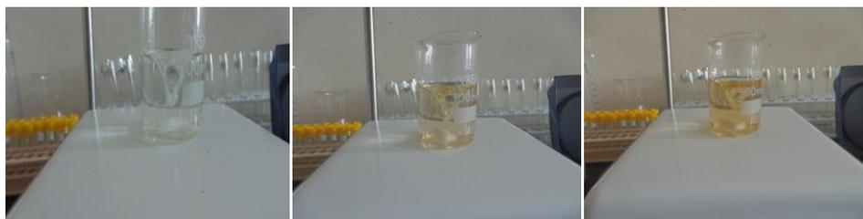
*Figure III-1 Préparation de nanoparticules d'argent à température ambiante. La couleur jaune indique la formation de nanoparticules d'argent*
