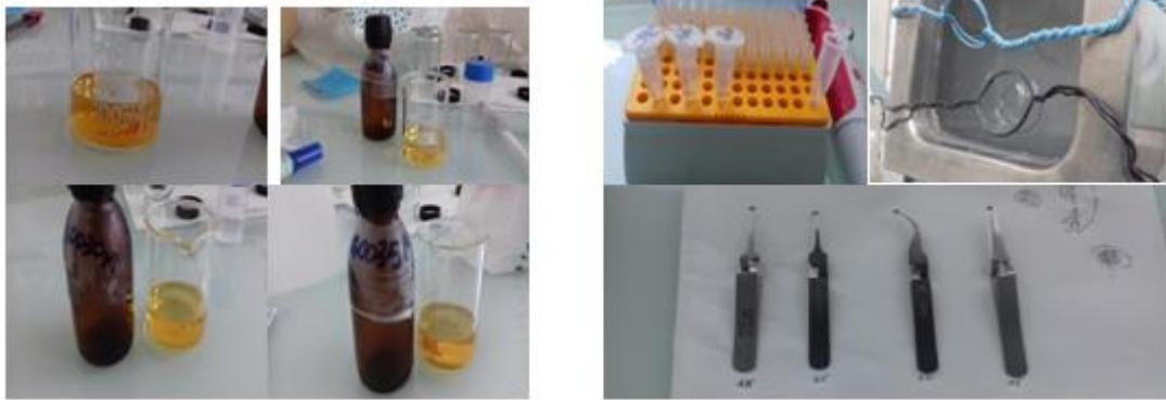
*Figure III-4 Préparation des échantillons pour la caractérisation par MET, chaque pince contient une grille de cuivre recouverte de Carbone sur laquelle on a déposé une solution diluée de nanoparticules d'argent.*
