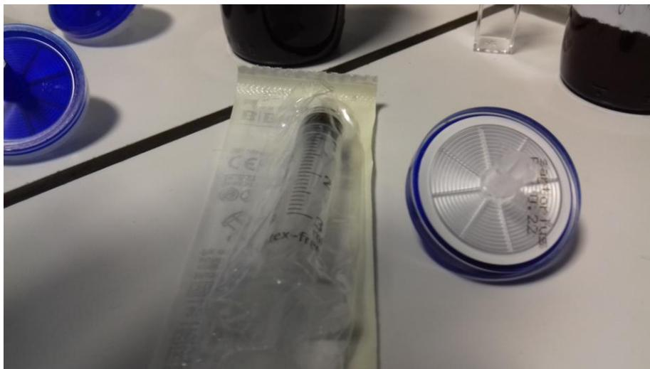
*Figure II-7 Filtre seringue 0.22µm utilisé lors de la caractérisation des échantillons par DLS*
