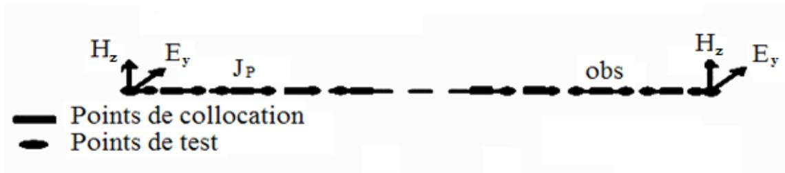
Figure IV.4 : Répartition des points de collocation et de test en 1-D.
