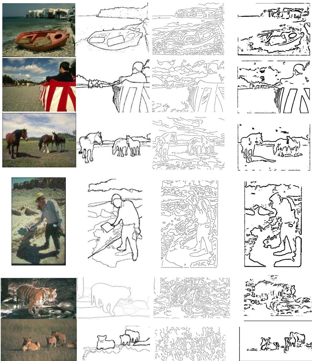
**Fig. IV.11** Illustration des bords obtenus en utilisant la méthode proposée par rapport au détecteur Canny. La première colonne contient l'image originale, la deuxième colonne contient les contours créés par l'humain suivis par les bords détectés par Canny et les résultats du détecteur proposé.
