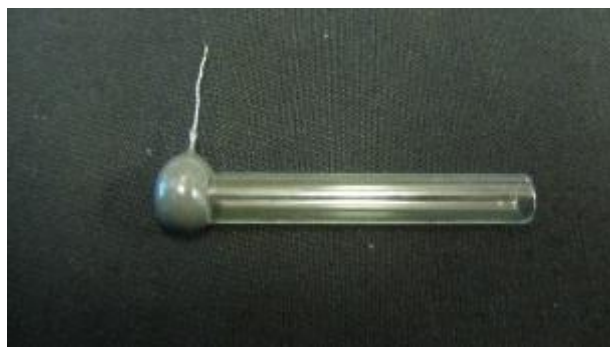
Fig. III.3 : Photo de l'ossature du réacteur faisant apparaître la résine enrobant l'électrode externe.
