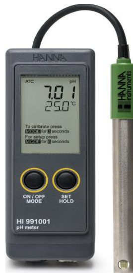
Fig. II.17 : Photo du pH mètre Hanna HI 991001 avec la sonde HI 1296D.
