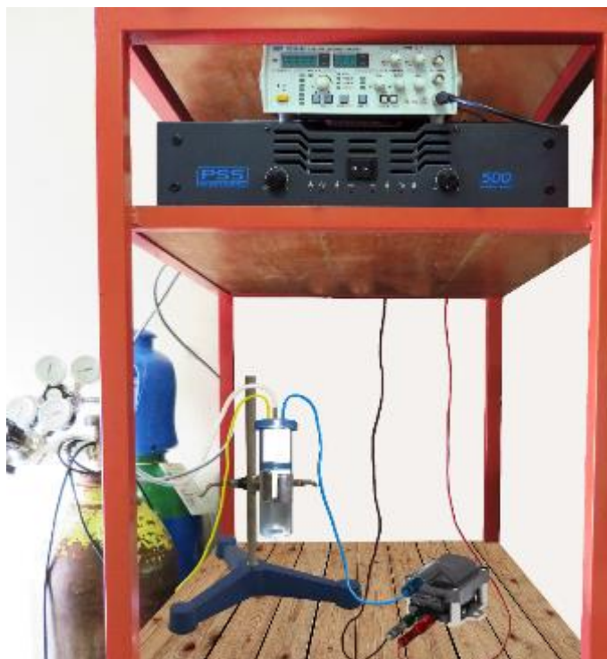
Fig. III.6 : Banc mis en place pour la création du jet de plasma avec une excitation AC.
