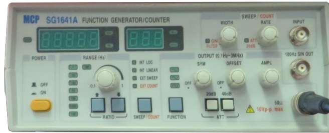
Fig. II.2 : Photo du générateur de fonctions MCP SG1641A.
