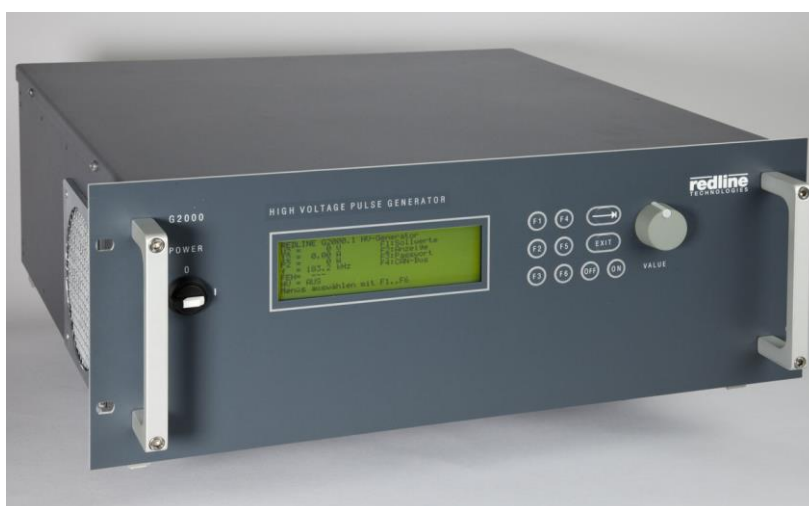
Fig. II.9 : Photo du générateur impulsionnel Redline G2000 [4].
