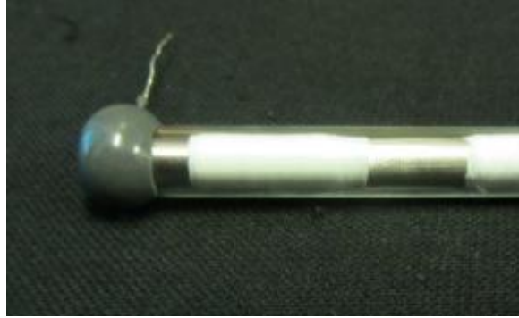
Fig. III.4 : Photo montrant deux enroulements de rubans en PTFE, utilisés pour centrer l'électrode interne (tube en acier inox) dans le tube de verre borosilicate.
