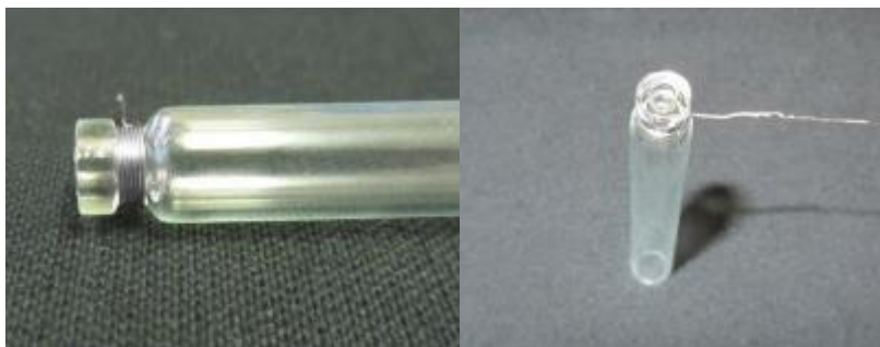
Fig. III.2 : Photos montrant l'enroulement de l'électrode externe du réacteur autour de la gorge du tube de verre borosilicate.
