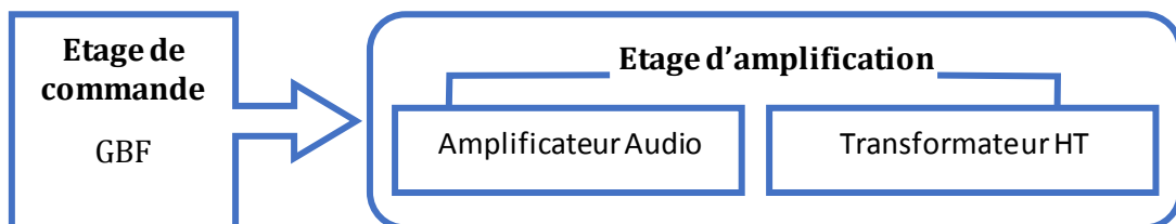
Fig. II.1 : Schéma synoptique du générateur haute tension alternative mis en place.
