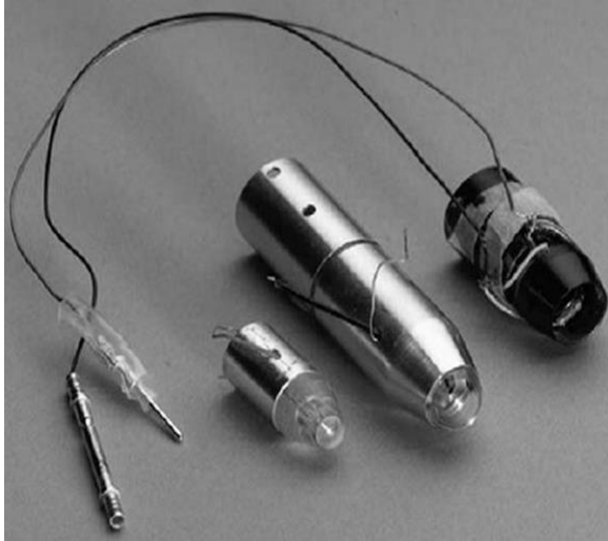
Figure 2.1-Le premier prototype de la capsule endoscopique
