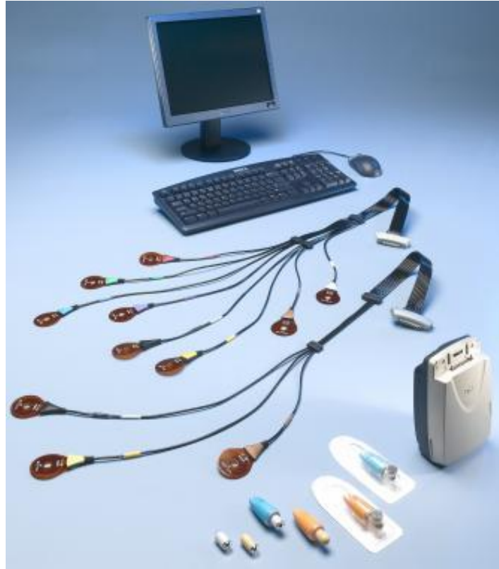
Figure 2.4- Système de capsule endoscopique : capsule, dispositif d'enregistrement et poste de travail.
