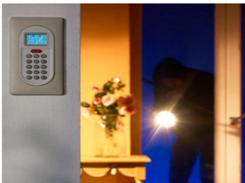
(g) Le clavier coordonné aux interrupteurs commande l'alarme en local ou à distance.
