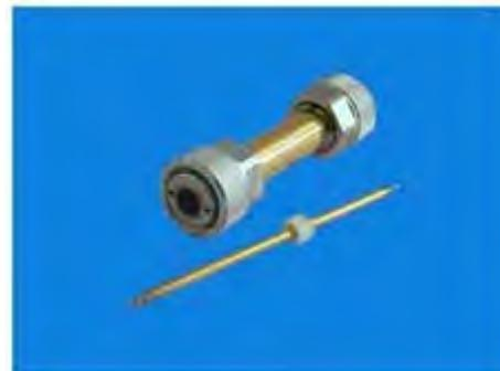
**Figure I.10.** Cellule de mesure ligne coaxiale [I.24].
