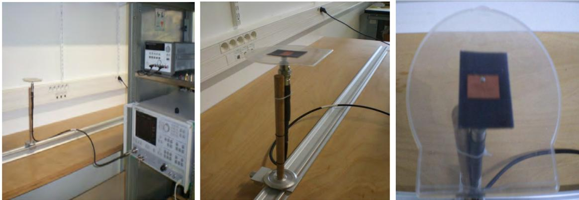
**Figure V.7.** Banc de mesure (VNA ANRITSU 37 397 C (40 MHz – 65 GHz) – support avec câble rigide anritsu et connecteurs – résonateur patch rectangulaire (RPR)
