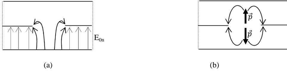
**Fig. II-6.** Le moment dipolaire électrique
