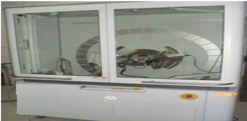
Figure 3.12: Photographique du diffractomètre : Emperean Panalytical
