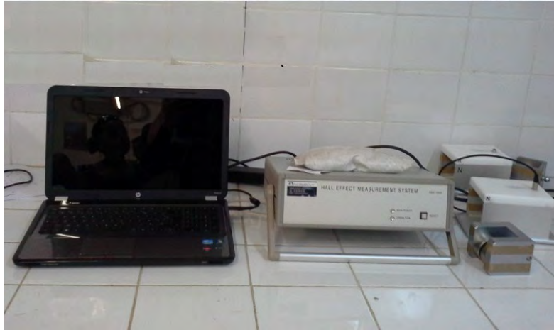
Figure 3.21 : Photographie du montage expérimental d'une mesure par effet Hall
