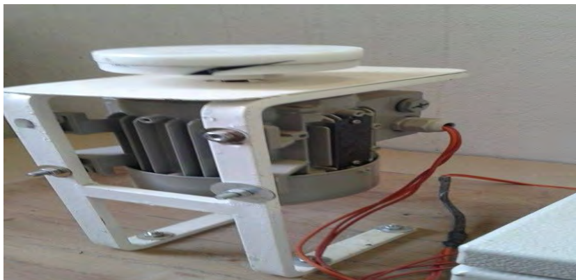
Figure 3.3 : Photographie de la partie mécanique du spincoater.
