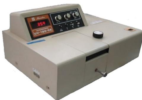
*Figure III.13 : Spectrophotomètre UV-Visible utilisé pour la mesure de la densité optique.*
