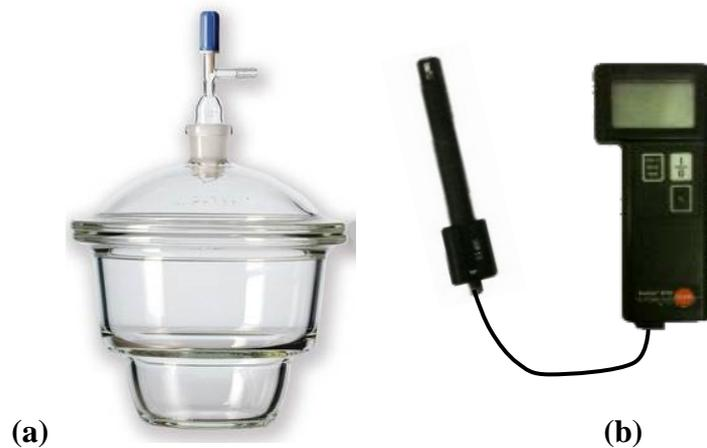
Figure III.23 : Dessiccateur utilisé pour le stockage des polymères traités (a), Hygromètre utilisé pour mesurer la température et le taux d'humidité (b).
