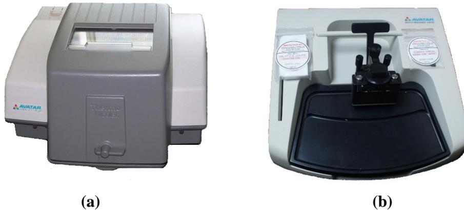
Figure III. 19 : Banc de spectroscopie FTIR Nicolet Avatar 360 (a) avec le module de réflexion HATR (b).
