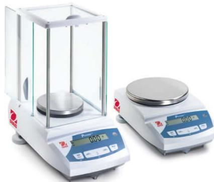
Figure III.15 : Microbalance Adventurer *OHAUS* utilisée pour la détection de la variation de masse des échantillons traités.
