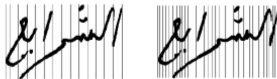
Fig 3. 14 – Segmentation en bandes uniformes et non-uniformes (figure extraite de [144]).
