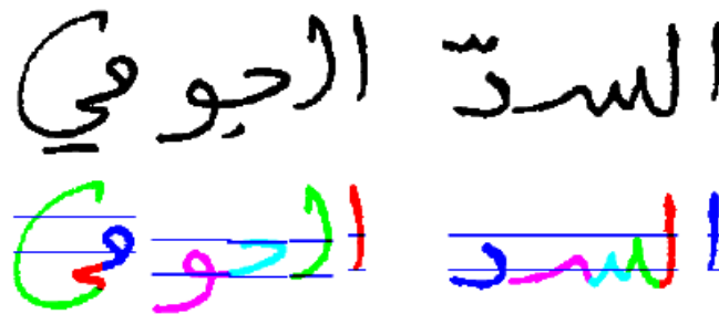
Fig 3. 7 – Exemple de segmentation en graphèmes (figure extraite de [127]).
