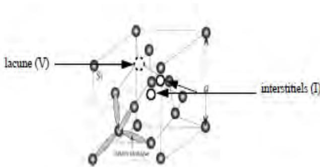
Figure III.25 Schéma des sites cristallins de type interstitiel et lacunaire.
