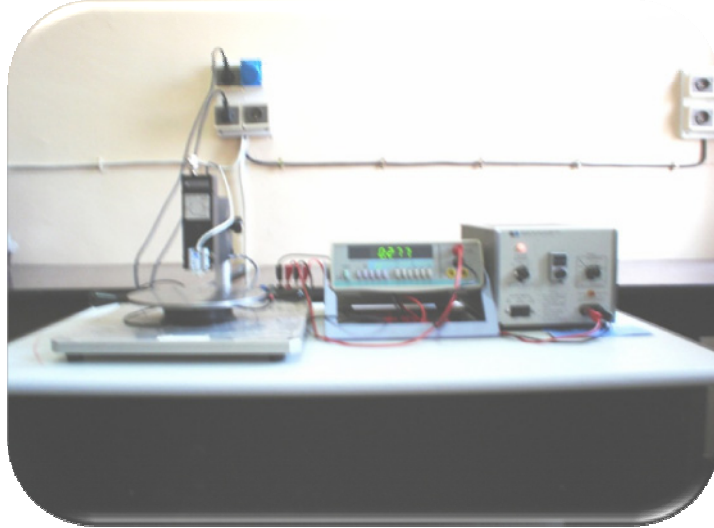
Figure I.15 : Photo d'un banc de mesure par les quatre pointes.
