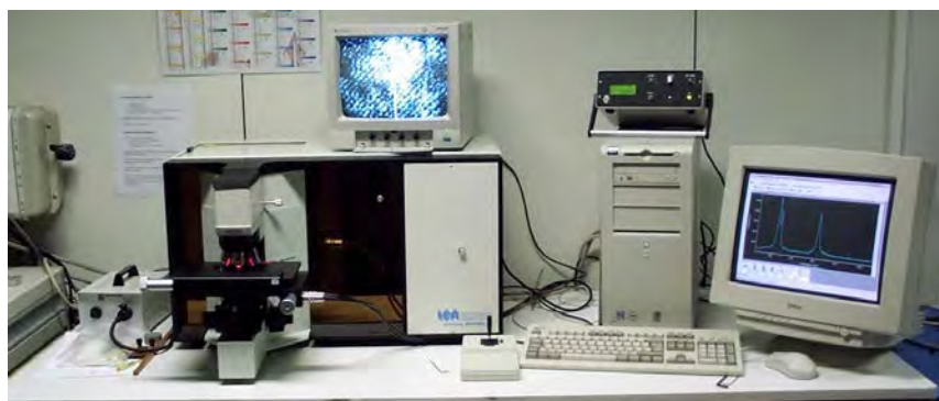
Figure 3.11. Dispositif expérimental du montage \mu -Raman utilisé dans ce travail.
