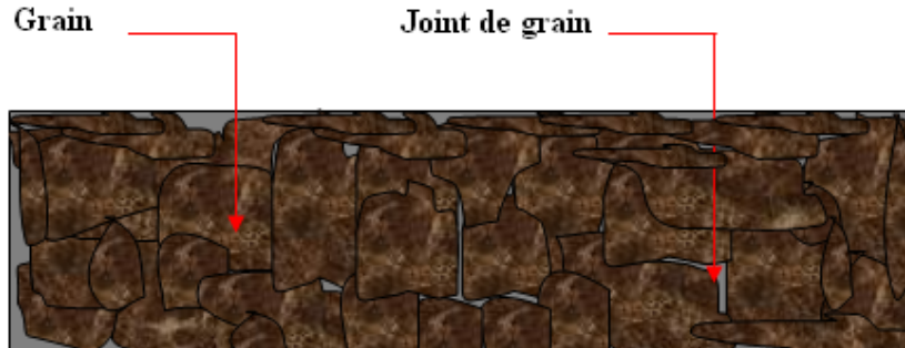
Fig.II.1. Structure granulaire d'un film de silicium polycristallin
