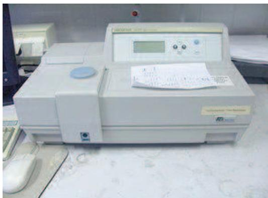
Figure 3. 7 : L'appareille de spectrophotomètre UV-Visible.
