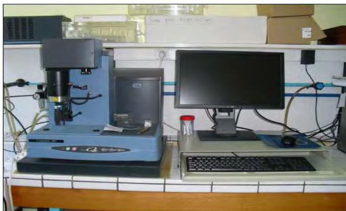
**Figure (5.2) : Appareil ATG (TGA – Q 50 V6.7/Build 203) utilisée**
