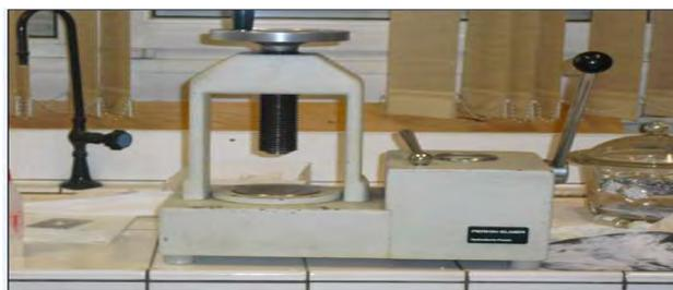
**Figure (5.7) : Pastilleuse (Perkin-Elmer)**
