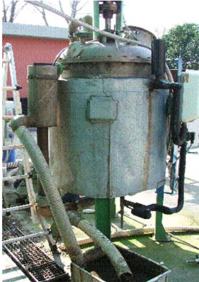
Figure II.1 : Digesteur anaérobie pilote (500 litres)
