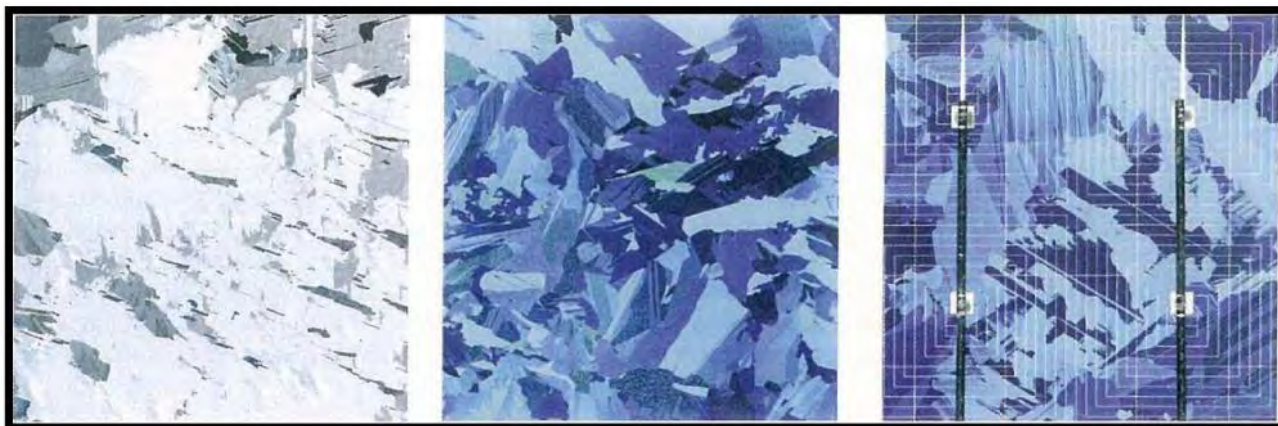
Figure 3.26 Gaufrette poly cristalline sans enduit anti-réfléchissant. Source : Photo watt
