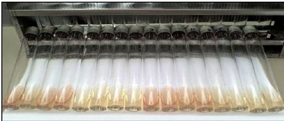
B- Le test VP pour les différents isolats, la couleur rose indique la fermentation acide butanoïque.
