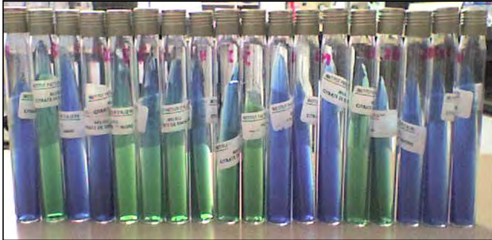
A- Virage du bleu de bromothymol de la couleur verte à la couleur bleu pour un résultat positif.
