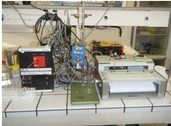
Figure 24 : Le montage de la chromatographie d'exclusion moléculaire : La colonne est reliée à la pompe et à l'enregistreur couplé au détecteur UV.
