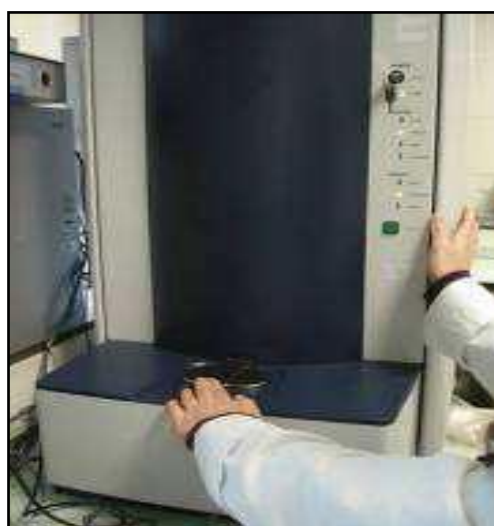
Figure 13 : Introduction de la cible Microflex LT.
