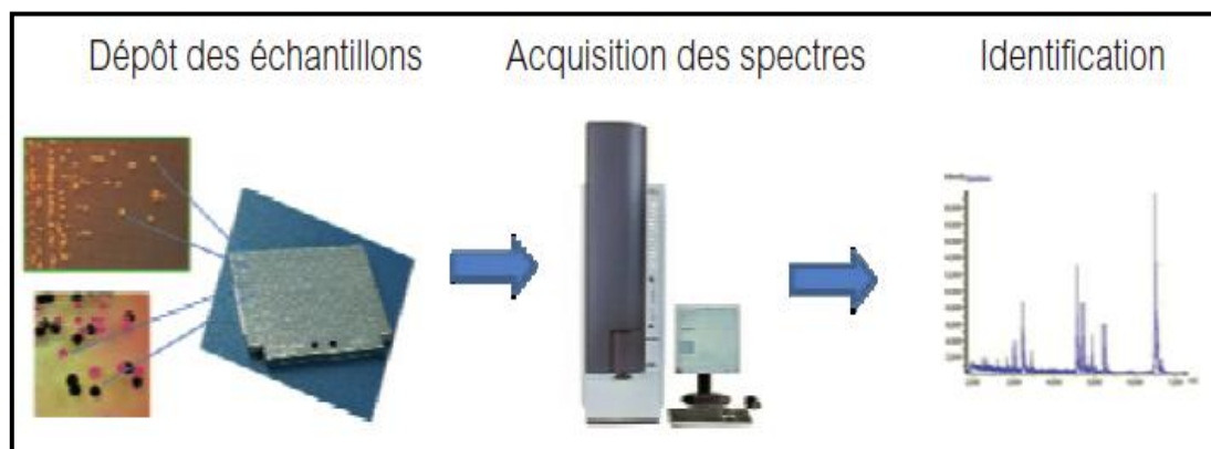
Figure 3 : Schéma d'identification par MALDI-TOF à partir des colonies.
