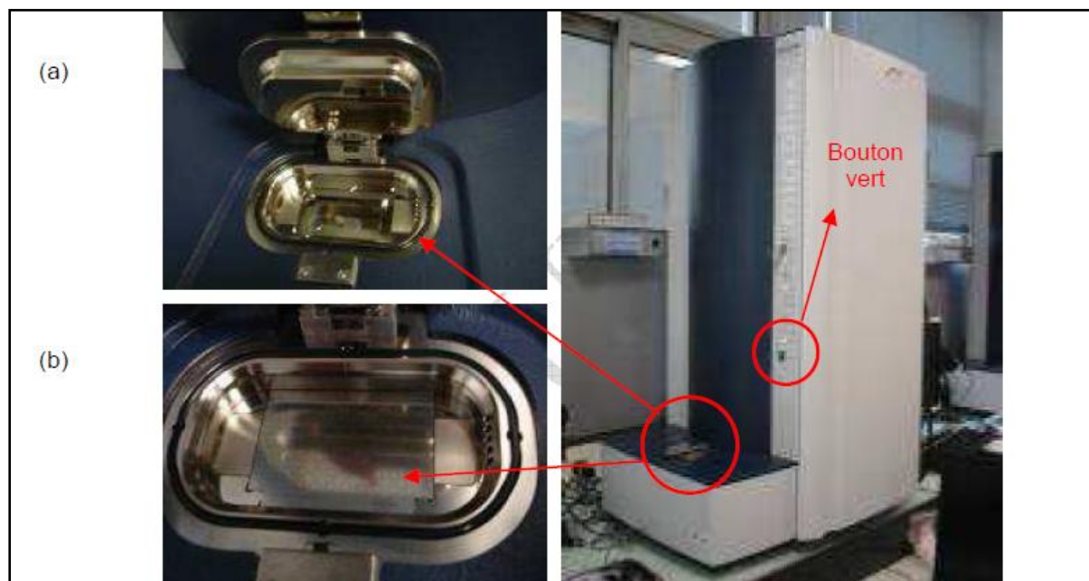
Figure 12 : Trappe d'insertion en position ouverte sans (a) et avec (b) cible.
