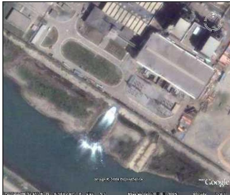
**Figure.14** : Photo aérienne du rejet de la centrale thermique électrique CTE.
