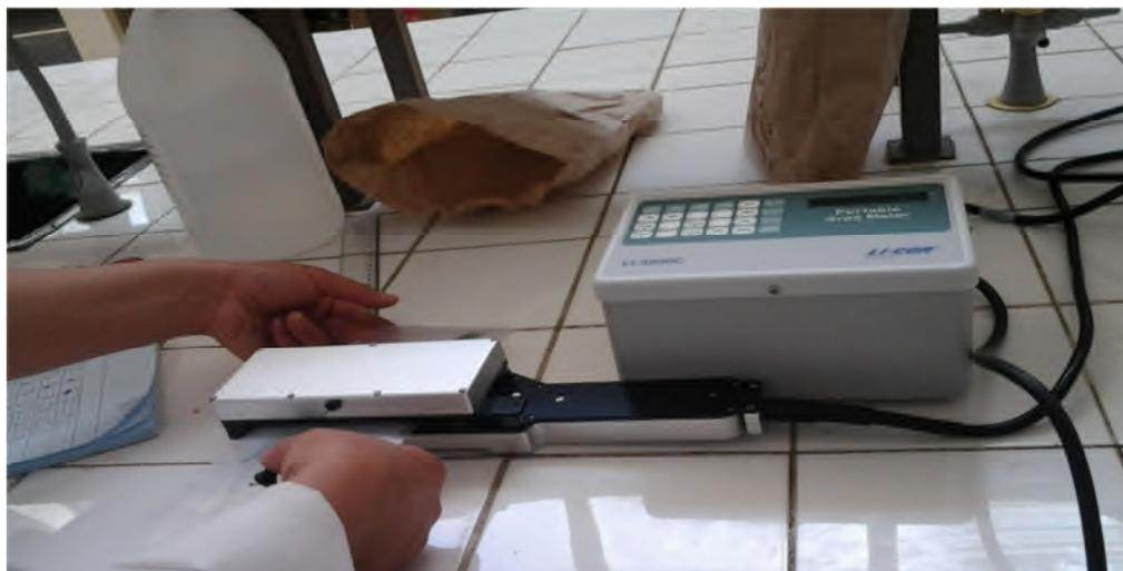
**Photo 9 :** PMI 3003C Appareil de mesure de la surface foliaire
