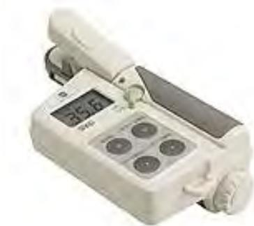
**Figure 8<sub>15</sub> : Metter SPAD-502**
