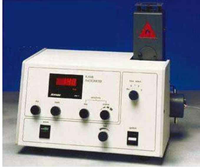
صورة (03) : جهاز Spectrophotomètre à flame من نوع JENWAY PFP7
