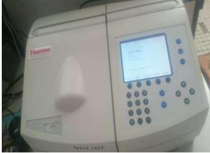
صورة (04) : جهاز Spectrophotometre المستخدم في التجربة من نوع Evolution e100
