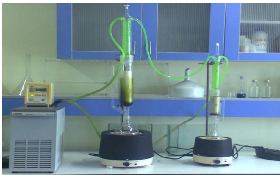
Figure 27. Photographie représentant un dispositif reliant deux Soxhlet sur leurs chauffes ballons à un Cryothermostats à circulation.
