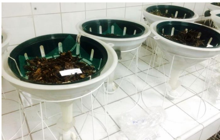
Figure 35. Extraction de la faune du sol sur appareils de Berlese (photo originale)
