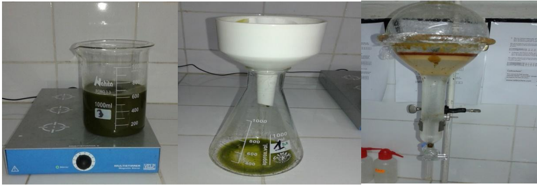
Figure 15. Extraction des tanins condensés d' Acacia horrida
