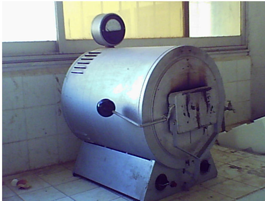
Photo 8 : Four à moufle utilisé pour la calcination
