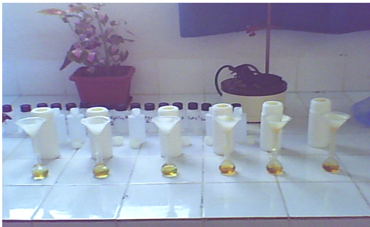
Photo 18 : Filtration du contenu des bombes à téflon dans des fioles de 20 ml.
