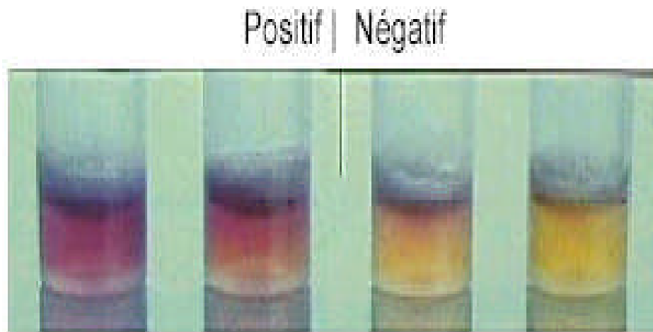
Figure n° 04: plage de couleurs de Premi®Test (Gaudin et al, 2006)
