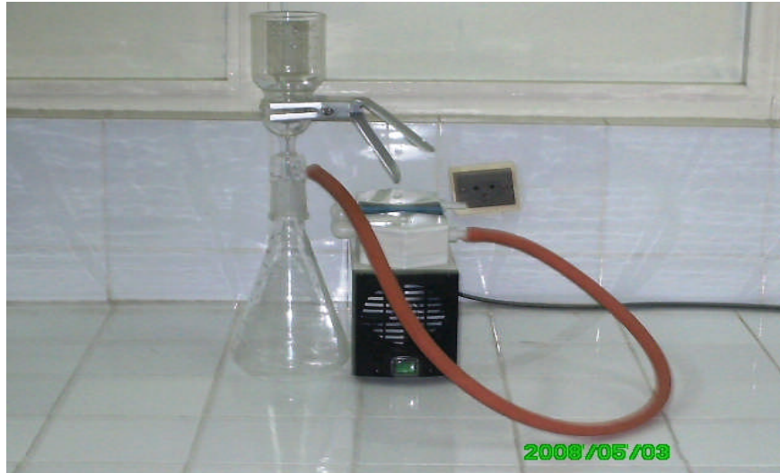
Figure n°25 : le dispositif de filtration.
