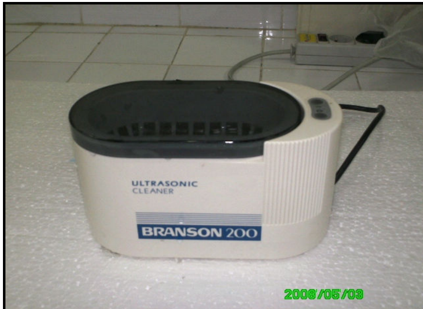
Figure n° 23 : Bain ultrason servant à l'élimination des bulles d'air emprisonnés dans les différentes solutions liquides utilisées durant l'optimisation.
