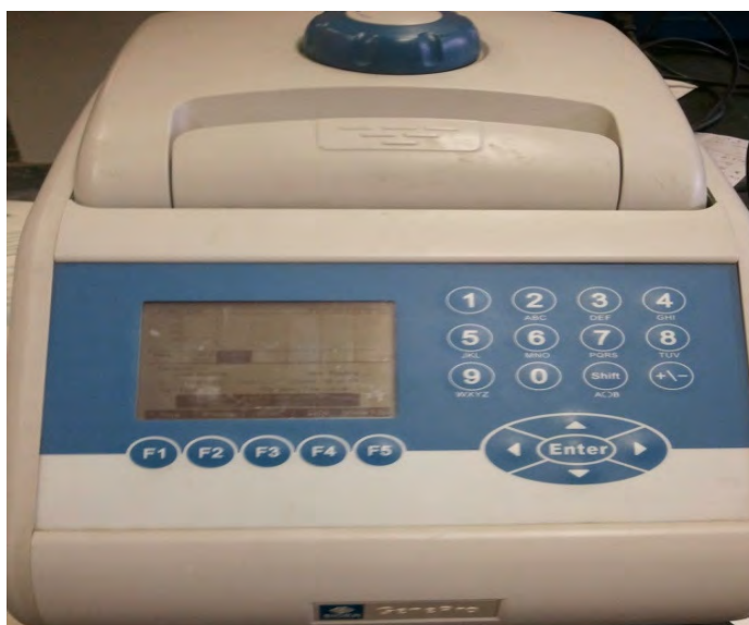
Figure 29 : Réaction d'amplification d'ADN réalisée dans le thermocycleur Genpro BIOER®
