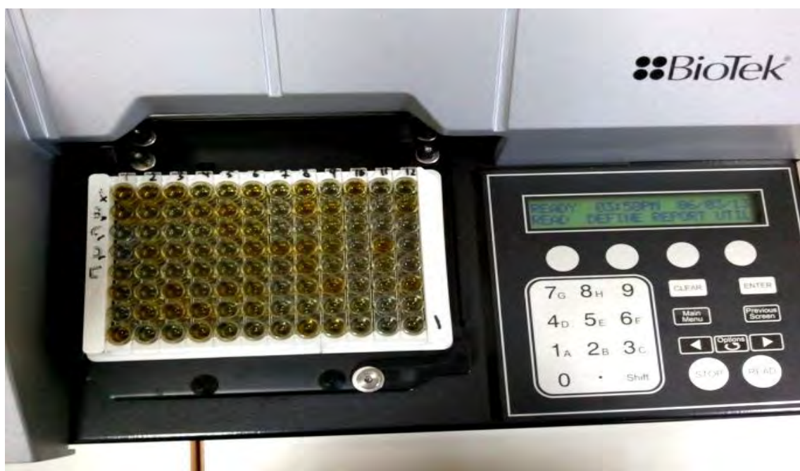
Figure 17 : Lecture des résultats (densité optique) par un lecteur de plaques ELISA (Biotek, Elx800) à 450 nm
