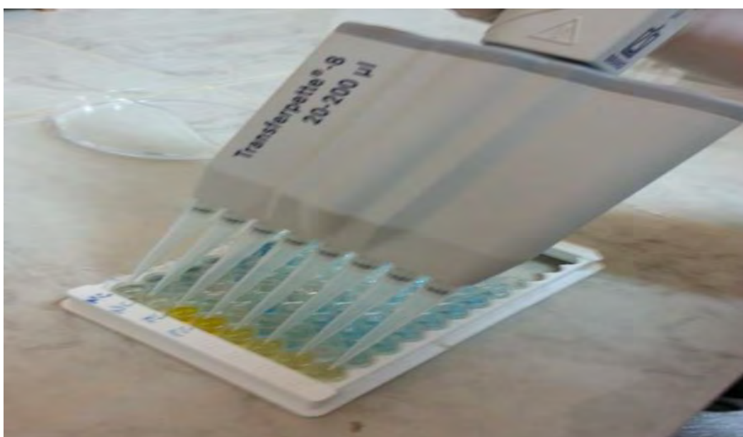
Figure 20 : Distribution de 100 µl de la solution d'arrêt dans chaque puits avant la lecture des résultats
