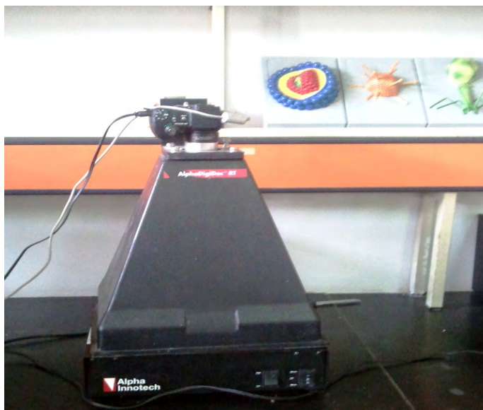
Figure 30 : Système d'imagerie AlphaDigiDoc ® RT, Alpha Innotech pour photographie du gel
