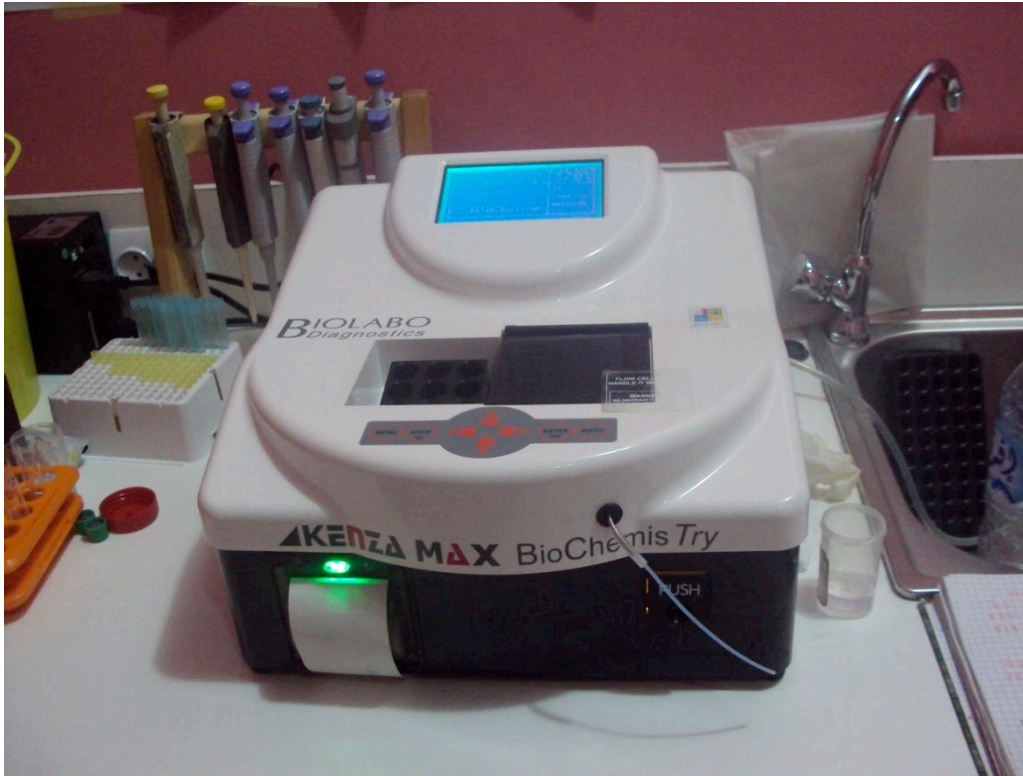
Figure 32: Image représentant l'appareil de Spectrophotométrie (Photo personnelle)
