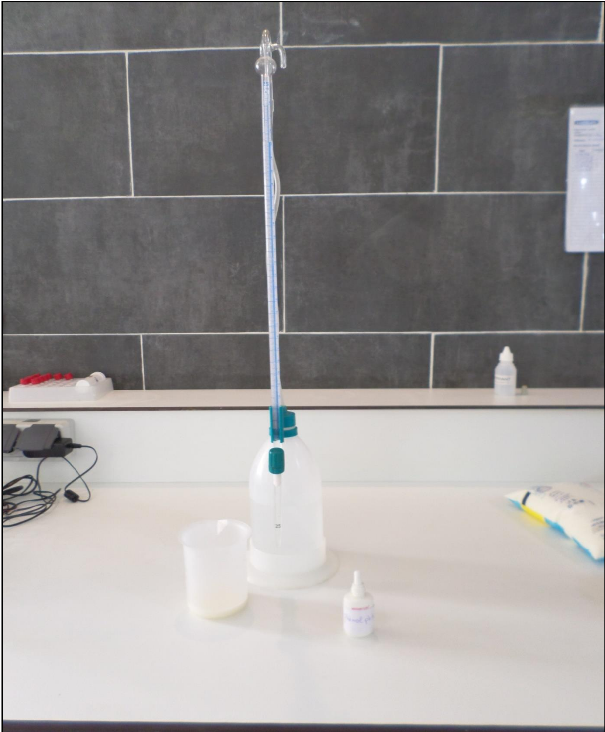
Figure 8 : Acidimètre avec un bécher contenant 10 mL de lait avec 3 gouttes de phénolphtaléine.
