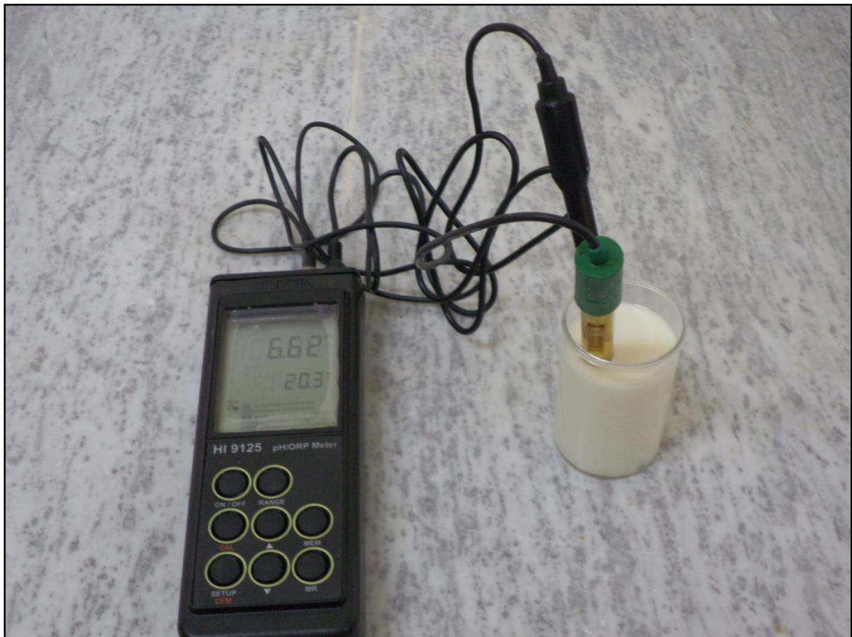
Figure 7 : pH-mètre portable type HANNA INSTRUMENT model HI 9125 pH/ORP Meter.
