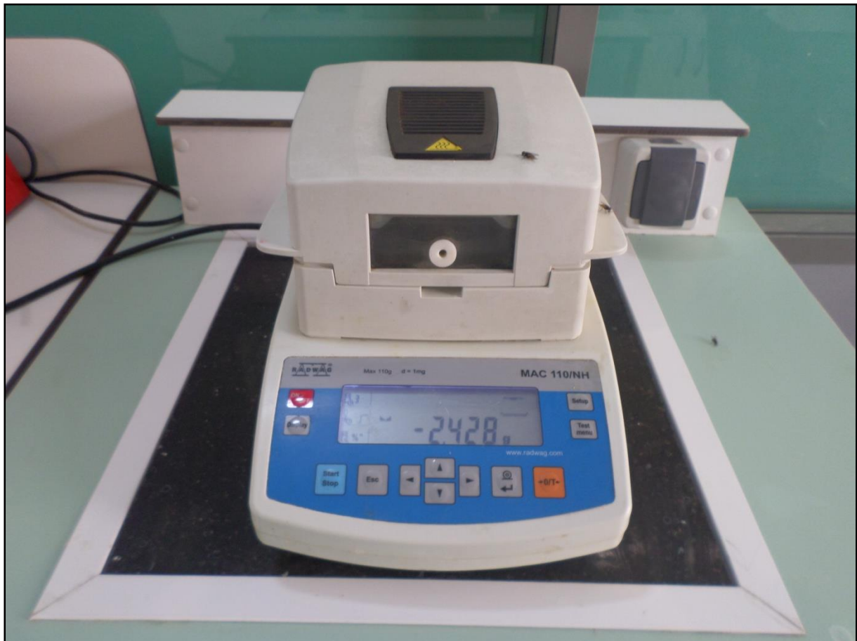
Figure 12 : Appareillage utilisé pour déterminer l'extrait sec total et l'humidité.
