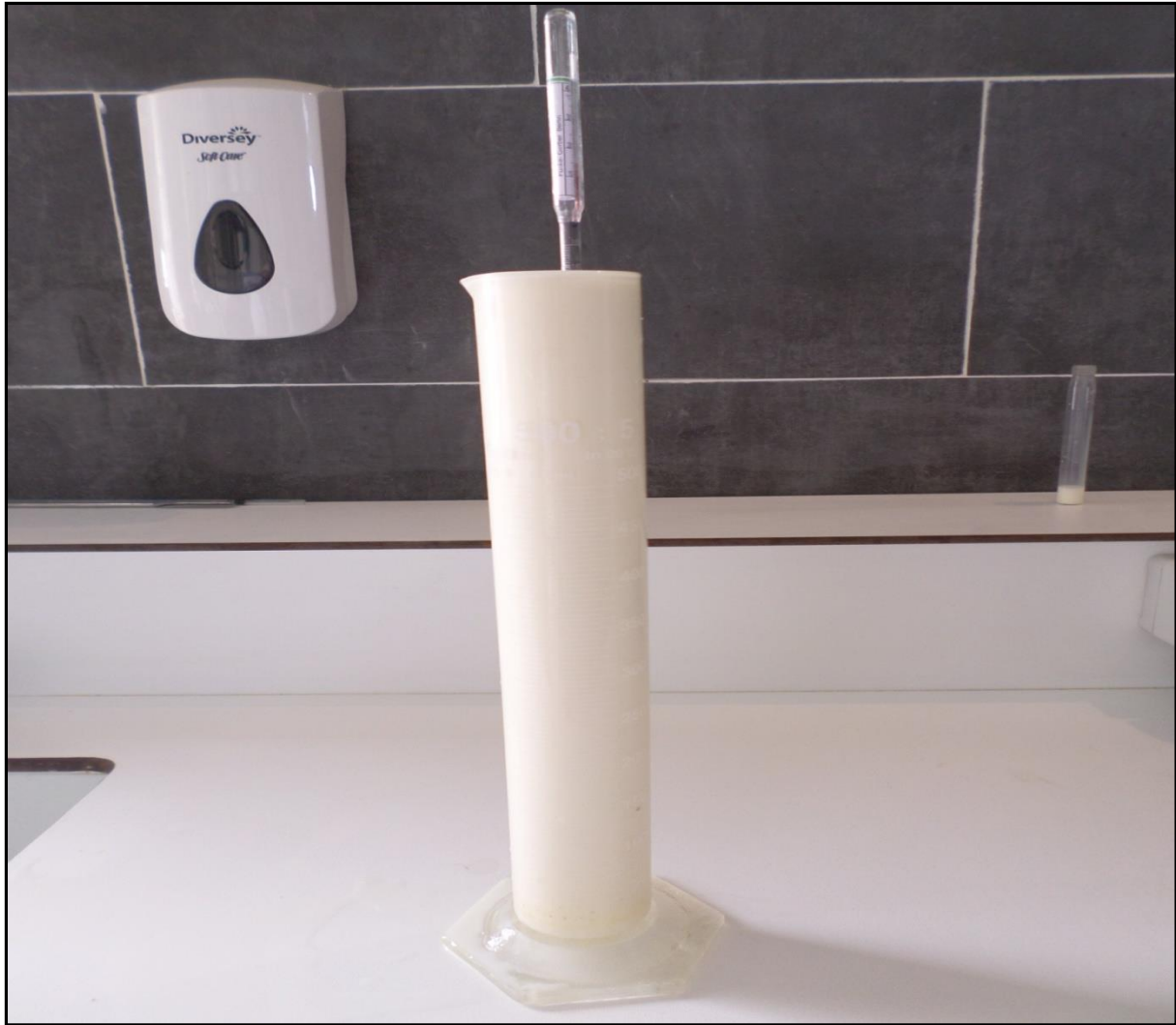
Figure 10: Thermo-lactodensimètre plongé dans une éprouvette pleine de lait.
