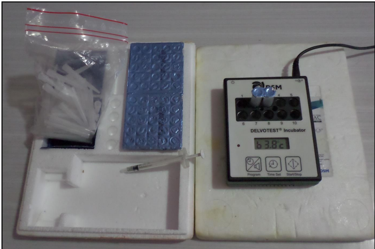
Figure 17 : Kit Delvotest® SP-NT (DSM, Hollande).
