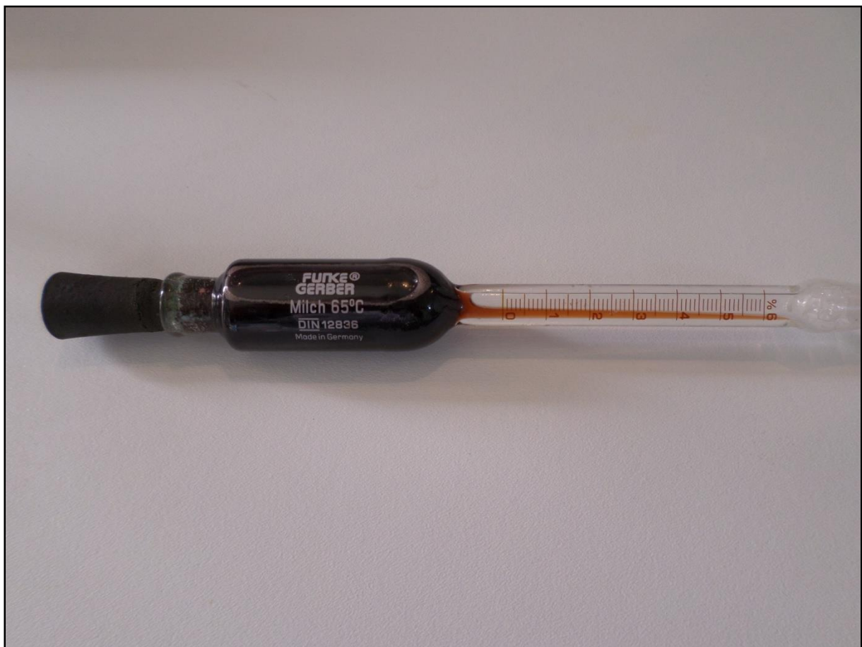
Figure 11: Butyromètre rempli d'acide sulfurique, de lait et d'alcool iso-amylique.
