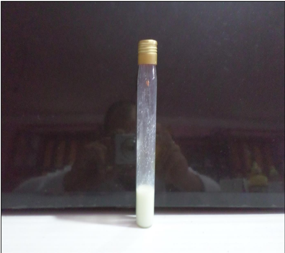
Figure 9 : Tube à essai contenant 2 mL de lait et 2 mL d'alcool éthylique 70° (précipitation sur la paroi).
