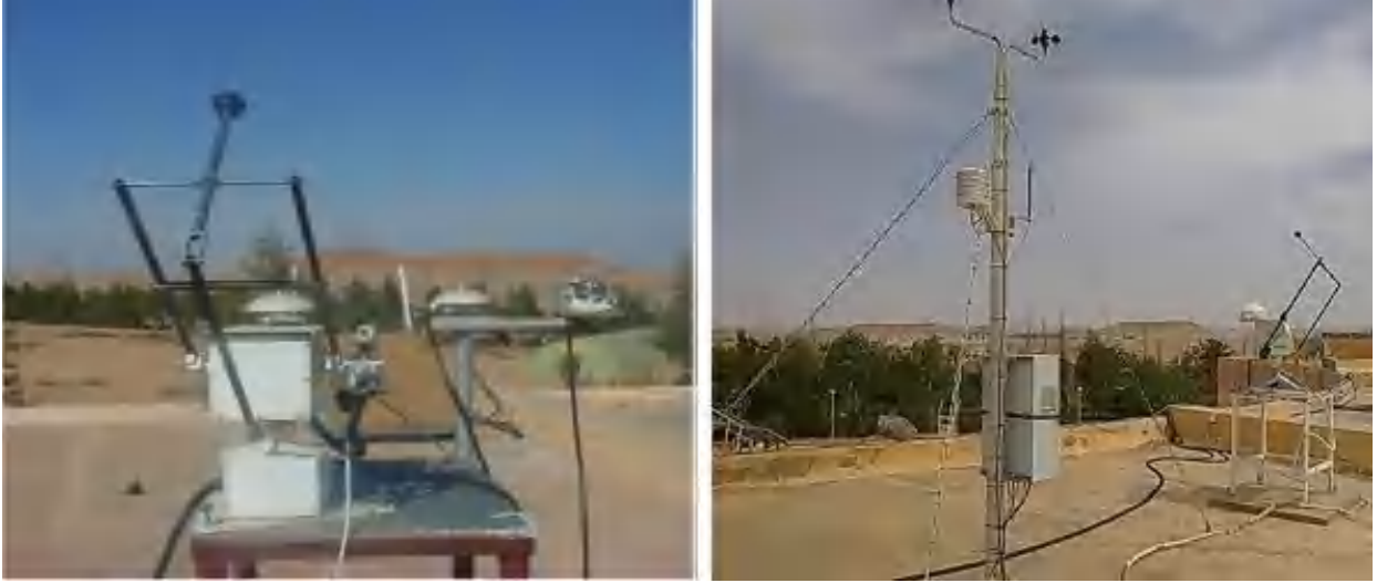
Figure 2.4 : Centrale météorologique dans la ville de Ghardaïa pour mesurer les paramètres climatiques [Modèle étudié]
