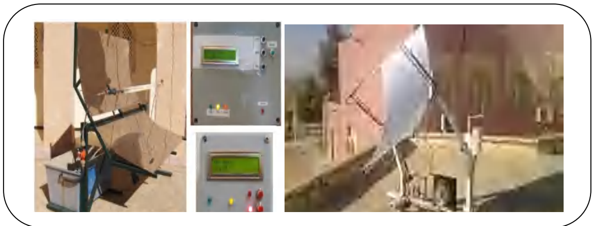
Figure 1.13 : Système de capteur solaire cylindro-parabolique dans la ville de Ghardaïa [21]
