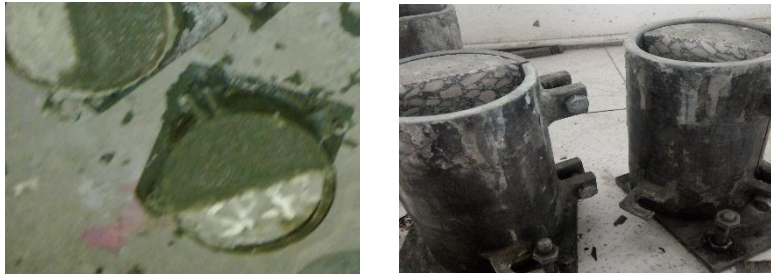
FigureV.4 : La mise en place des substrats dans les moules et application de la réparation.
