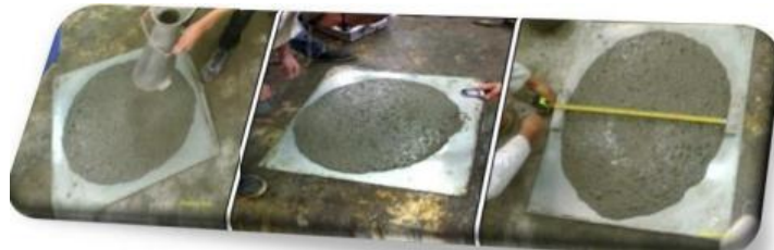
FigureVI.1 : Essais de l'étalement.
