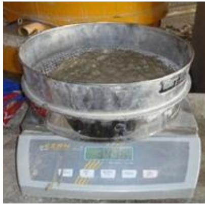
FigureVI.3 : Essai au tamis.
