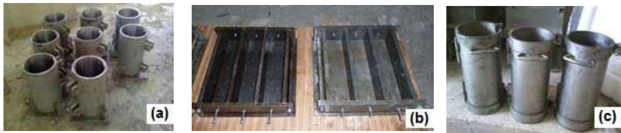
FigureIV.4 : Les éprouvettes utilisées (a) Cylindriques 10x20cm (b) prismatiques 7x7x28cm (c) Cylindriques 16x32cm.
