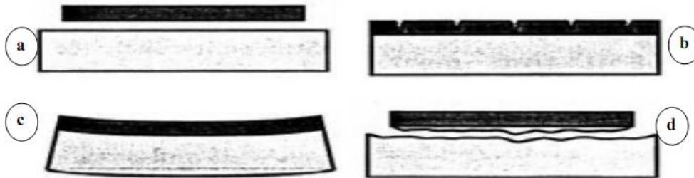
Figure II.13 : Les comportements mécaniques d'une réparation soumise au retrait [Saucier et al 1990].
