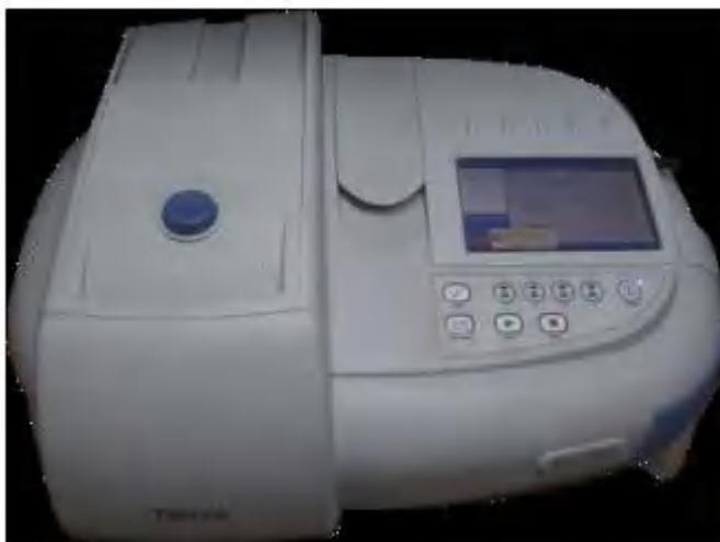
**Figure II. 7 :** Spectrophotomètre UV-Visible «Thermo scientific».
