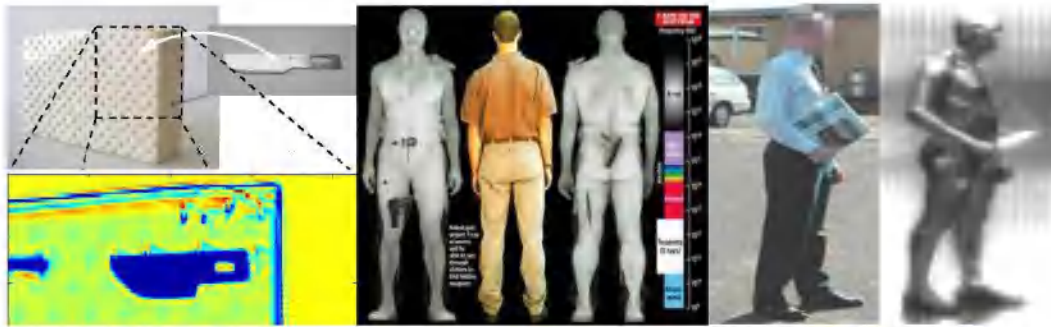
Figure I.32 : Imagerie THz utilisée dans des applications de sécurité [56], [57].
